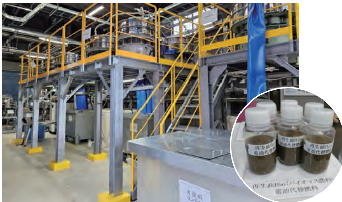
飲食店や食品工場から排出される廃液から、油分のみを分離回収した重油代替燃料「再生油B i o」。ニーズに対応し、2024年3月には製造ラインを2倍に増強し、製造能力4,320 t/年とした。
