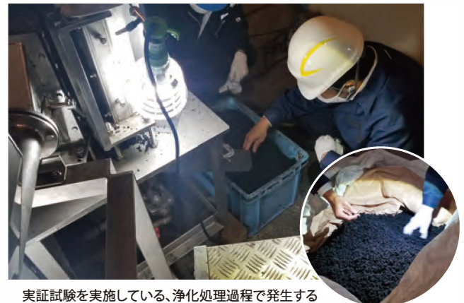
実証試験を実施している、浄化処理過程で発生する汚泥の燃料化。有機性廃液を脱水処理した際に残る汚泥を脱塩・乾燥し、化石燃料に代わる固形燃料として再生する。
