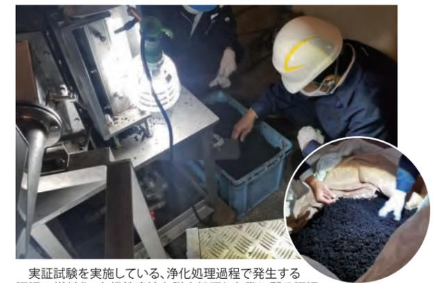
実証試験を実施している、浄化処理過程で発生する汚泥の燃料化。有機性廃液を脱水処理した際に残る汚泥を脱塩・乾燥し、化石燃料に代わる固形燃料として再生する。
