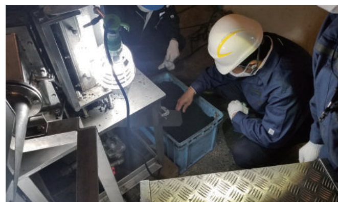
浄化処理過程で発生する汚泥の燃料化について、2020年10月より、実証試験を本格開始。有機性廃液を脱水処理した際に残る汚泥を脱塩・乾燥し、化石燃料に代わる固形燃料にする。2023年度の事業開始、年間5,400トンの燃料製造を目指している。
