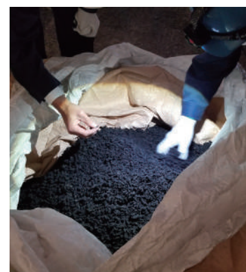
浄化処理過程で発生する汚泥の燃料化について、2020年10月より、実証試験を本格開始。有機性廃液を脱水処理した際に残る汚泥を脱塩・乾燥し、化石燃料に代わる固形燃料にする。2023年度の事業開始、年間5,400トンの燃料製造を目指している。
