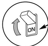
2. 住宅用分電盤の太陽光発電システム専用ブレーカをON (入) にします
